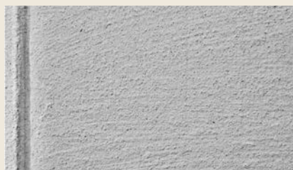
Imitacja strukturalnego tynku nakładanego „z pędzla” w zagęszczonym gruncie Optosan RissGrund.
