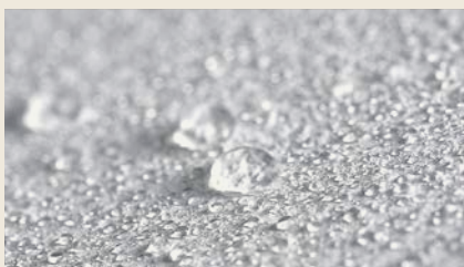
Charakterystyczny efekt „odpychania wody” na wysoko-hydrofobowej powierzchni farby silikonowej.
