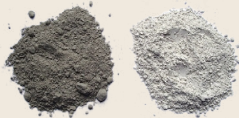
Spoiva z trassem Optosan jako jedyne na rynku są w kolorze starej bieli. Po lewej wapno hydrauliczne HL 5, po prawej Optosan TrassKalk.
